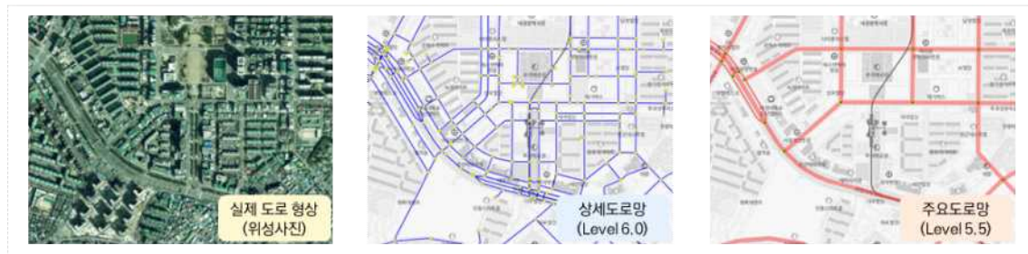
〈그림 2-24〉 주요도로망(Level5.5) 차량 모빌리티 기반지도 구축 예시
