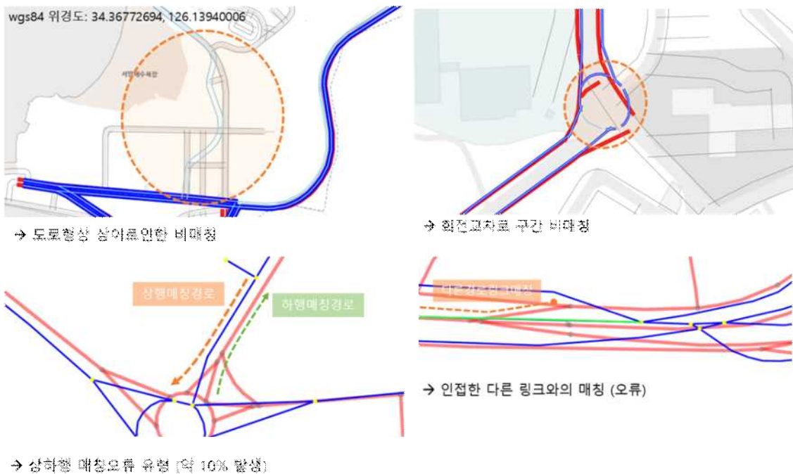
〈그림 2-28〉 고해상도 도로망과 기존 Level6.0 데이터와의 관계정보 구축 시스템(프로토타입) 결과
