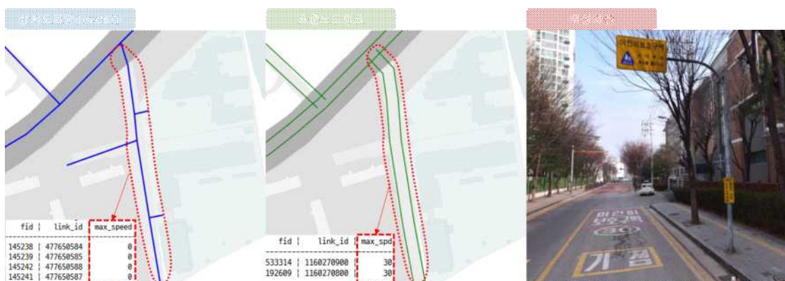
<그림 2-18> 상세도로망(Level6.0) 링크 내 누락 제한속도 입력
