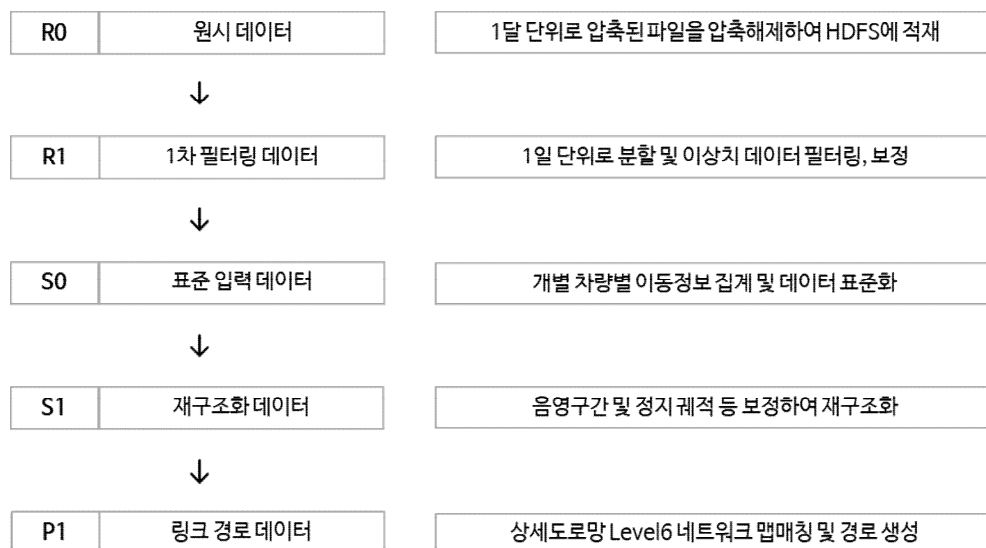
<그림 9-4> 포인트 기반 데이터 전처리 및 경로 데이터 가공 프로세스
