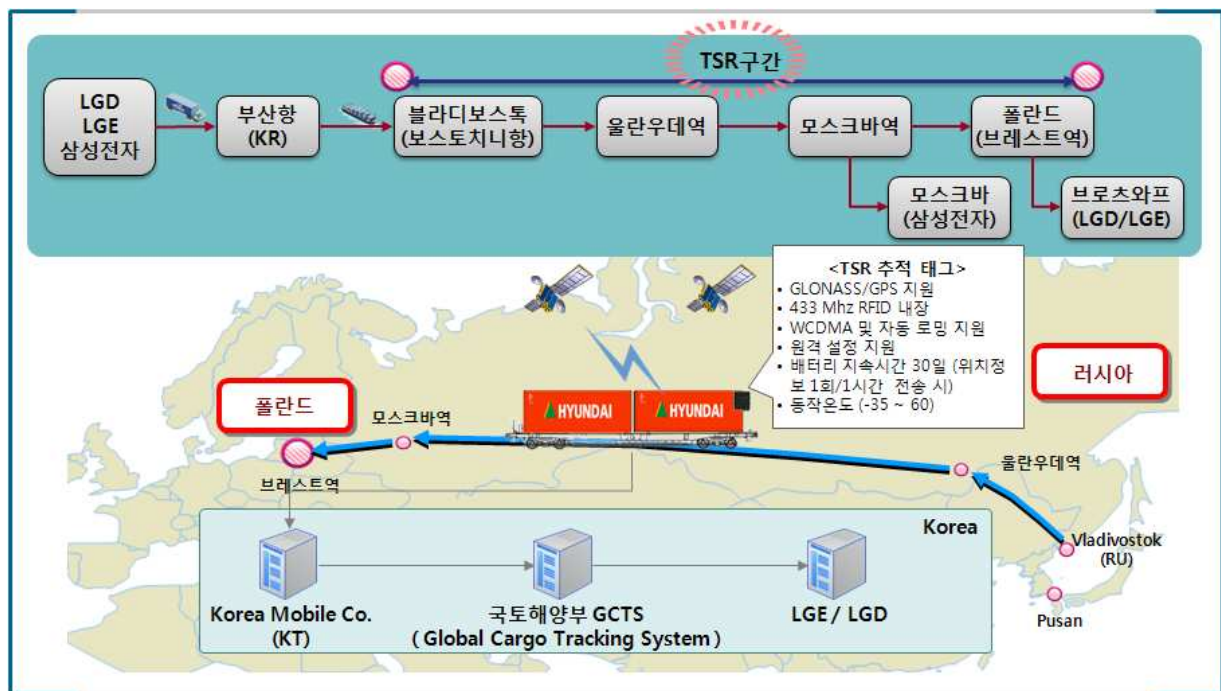
<그림 5-2> RFID 및 인공위성을 이용한 컨테이너 화물 추적관리
