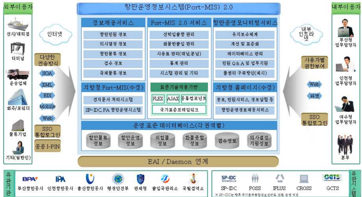
&lt;그림 4-3&gt; PORT-MIS 2.0 목표 시스템 구성도
