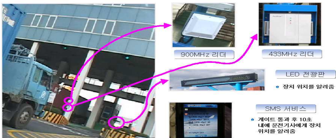
<그림 4-4> 게이트 반출·입 RFID 장비 설치사례
