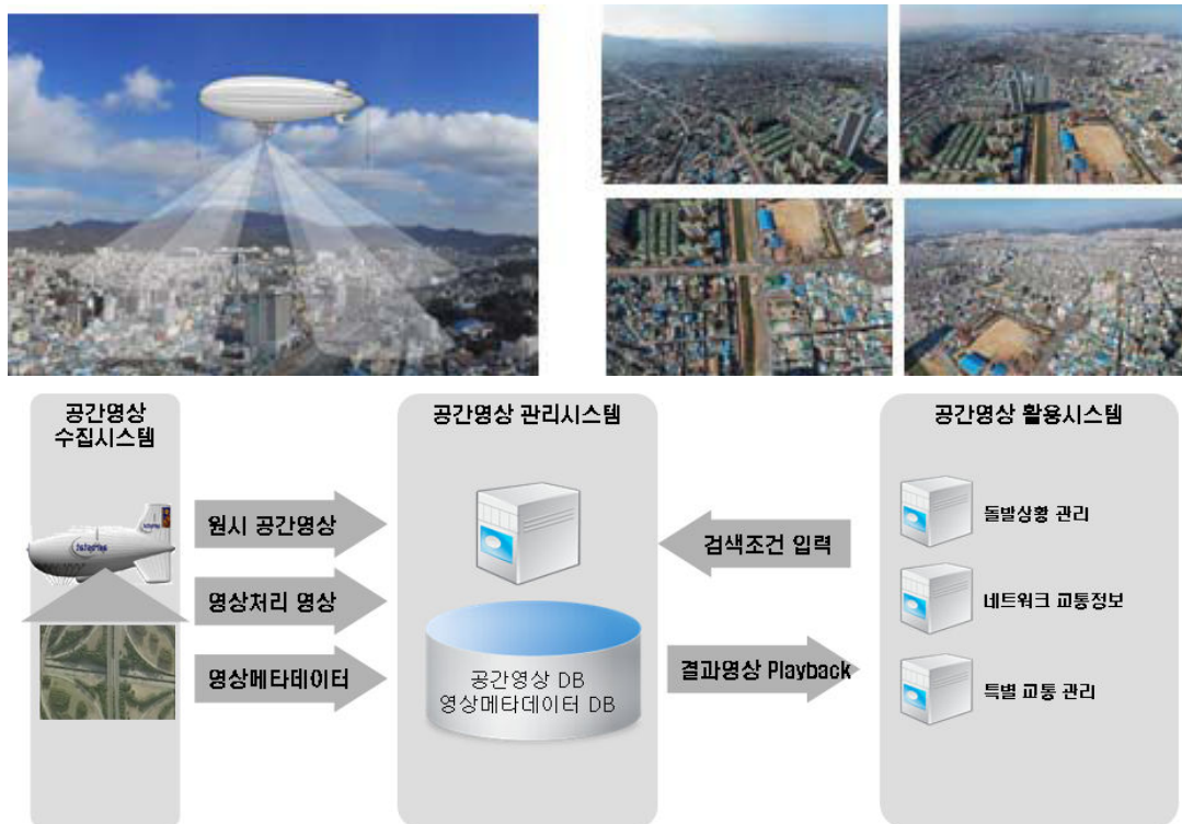
<그림 3-20> 비행선을 활용한 광역 영상 수집 및 영상 활용 교통관리 시스템 구성도
