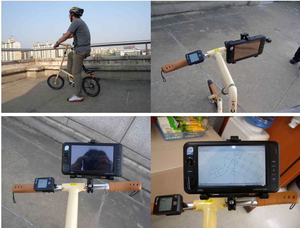
<그림 2-30> 자전거를 활용한 조사시스템 구성(안)
