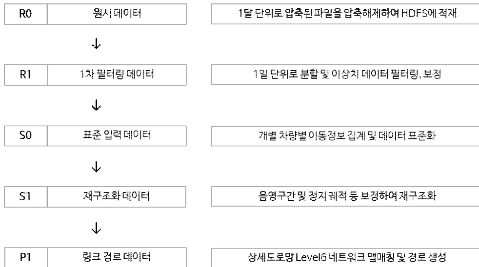
<그림 10-3> 포인트 기반 데이터 전처리 및 경로 데이터 가공 프로세스
